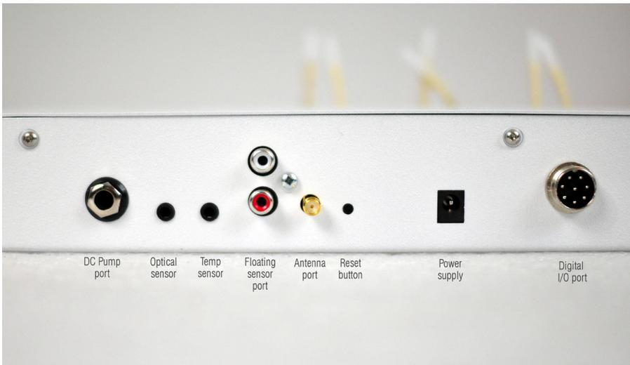
**DC-Pumpe (DC Pump port)** - Anschluss an DC-Pumpe (ATO-Pumpe)
