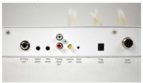
**DC pump(Pompe DC)** – port conçu pour la pompe DC (pompe de recharge ATO)
